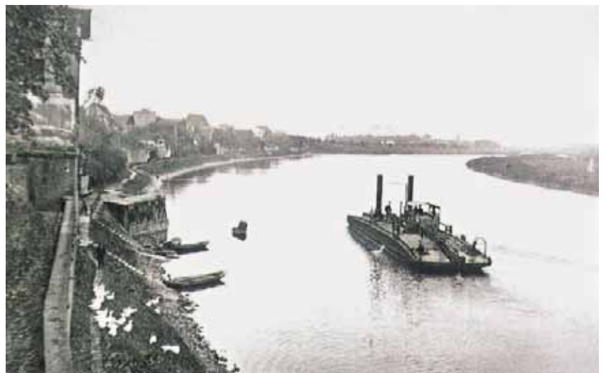
Abb. 2: Im Jahre 1878 kamen auf dem Neckar die ersten Ketten-schlepper zum Einsatz, welche nach dem Ausbau des Neckars bzw. der Errichtung der Staustufen zwischen Mannheim und Heilbronn um 1930 durch die Großschifffahrt abgelöst wurden
