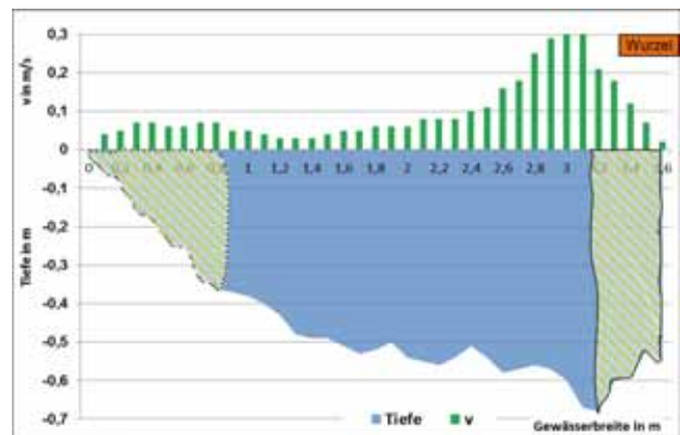
Abb. 57: Die Wassertiefe und die Strömungsgeschwindigkeiten entlang des Quertransektes im Kirbach kurz vor der Einmündung in die Metter (K3). Nicht nur der unterspülte Wurzelstock der Erle am rechten Ufer, sondern der gesamte Gumpen stellt hier ein gutes Strömerhabitat dar. Der Gumpen befindet sich kurz unterhalb einer Linkskurve des Kirbachs, so dass hier auch bei hohen Abflüssen strömungsarme Zonen vorhanden sind. Bei Mittelwasser steigt die Wassertiefe nur um 20 bis 30 cm an.
