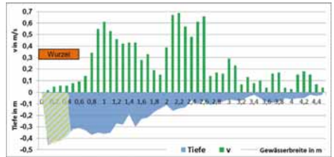
Abb. 55: Die Wassertiefe und die Strömungsgeschwindigkeiten entlang des oberen Transektes in der Metter oberhalb von Großsachsenheim (M4). Die schraffierte Fläche kennzeichnet das gute Strömerhabitat im Bereich des stark unterspülten Wurzelstockes der Erle.
